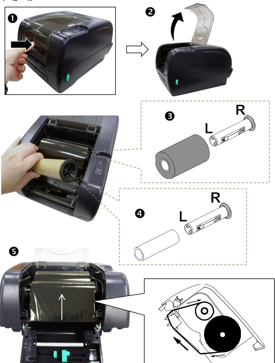
Loading Media/安装標籤/安装标签/メディアの読み込み/Загрузка носителя/ Medien werden geladen/Chargement des medias/Cargando medios/Caricamento dei media/ تحميل الوسائط
