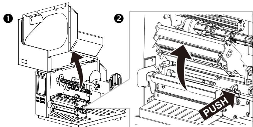
Loading Media/安裝標籤/安装标签/メディアの読み込み/Загрузка носителя/ Medien werden geladen/Chargement des medias/Cargando medios/Caricamento dei media تحميل الوسائط
